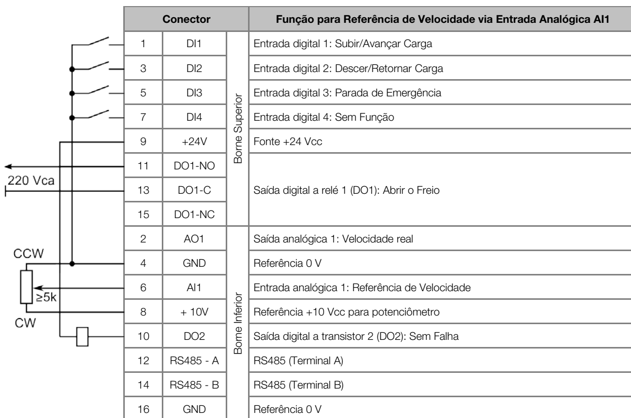
Figura 2.4 – Sinais no conector do módulo plug-in CFW500-IOS para movimentação de carga com referência de velocidade via entrada analógica AI1
