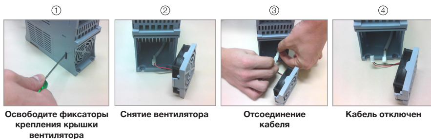
Рисунок 6.1: Снятие вентилятора радиатора охлаждения
