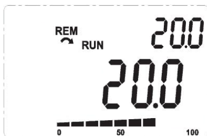
Figura 16.3: Exemplo da HMI no modo monitoração para a utilização do regulador PID
