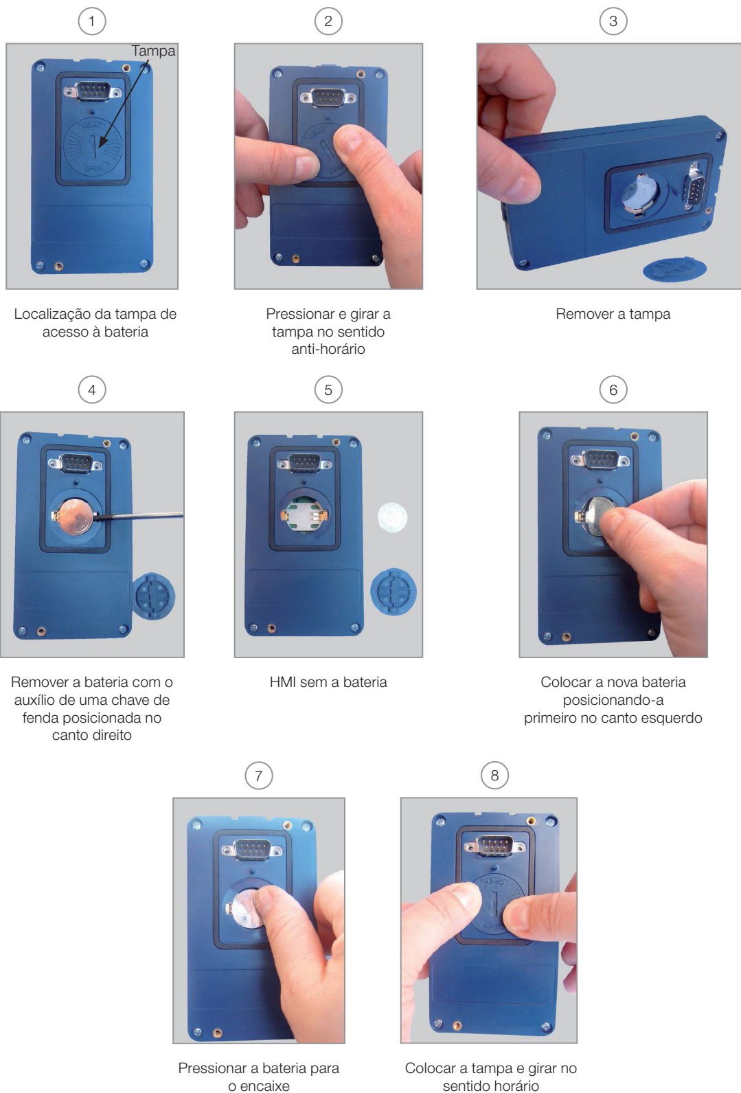
Figura 4.4: Substituição da bateria da HMI
