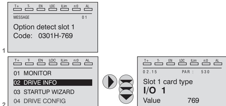
1 - All'accensione il drive riconosce la presenza della scheda opzionale nello slot di espansione 1, sul display per alcuni secondi viene visualizzato questo messaggio.
