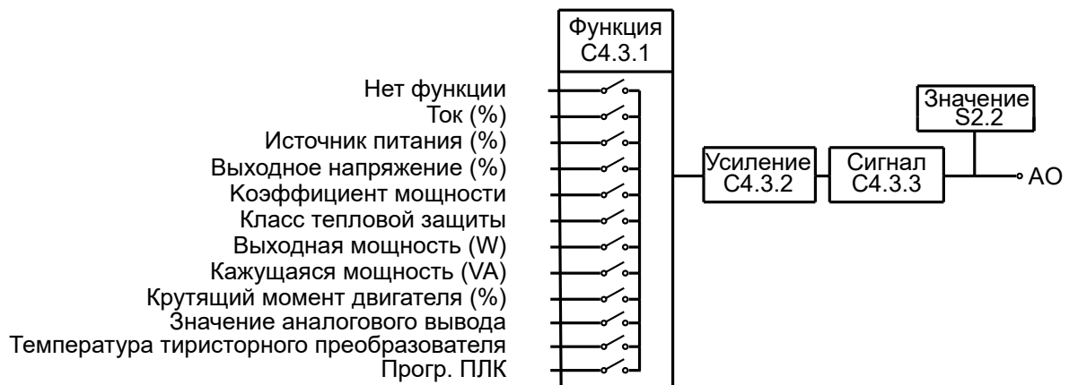
Рис. 11.12: Блок-схема аналогового выхода
