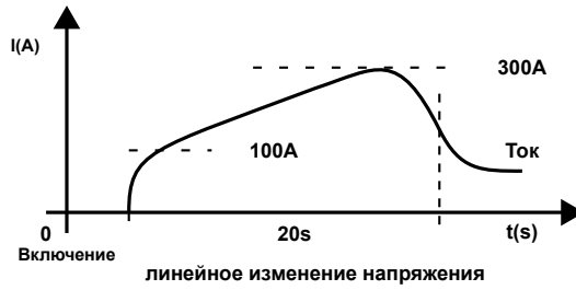
Рис. 13.24: Пример кривой тока при запуске с линейным изменением напряжения
