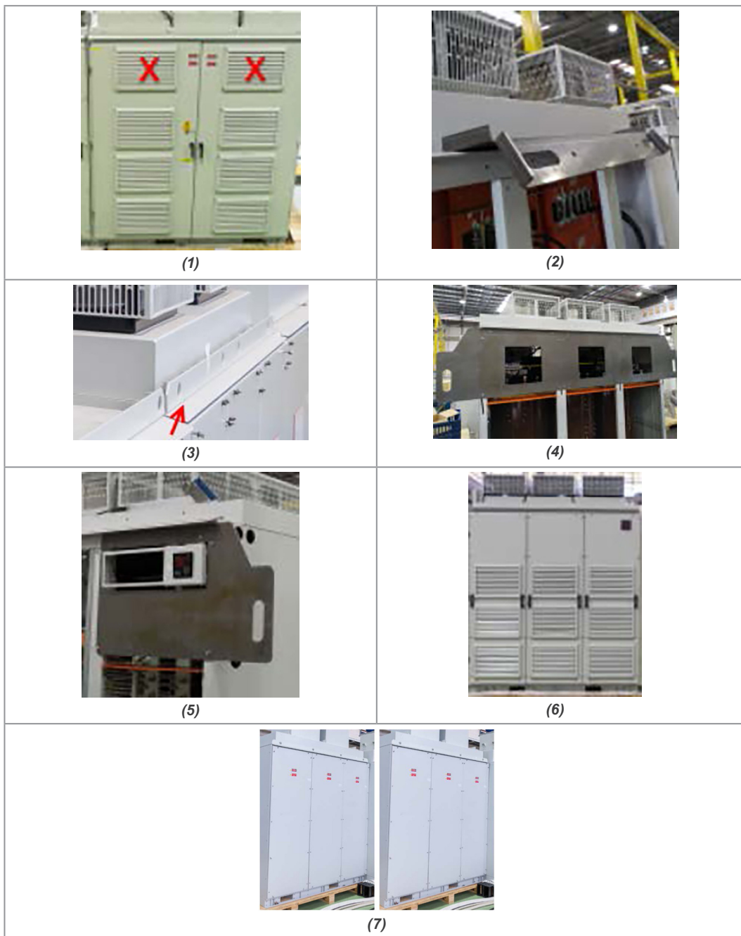
Рис. 6.4: Процедура снятия усилений для транспортировки авиатранспортом с MVW3000
