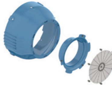
Figura 24 - Sistema de montagem que garante níveis de ruídos reduzidos
