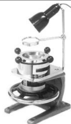
Figura 48: Exemplo de equipamento para determinar o embutimento
