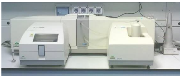
Figura 45: Exemplo equipamento para análise de granulometria
