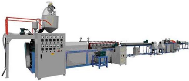
Figura 24: Exemplo de extrusora com esteira longa
