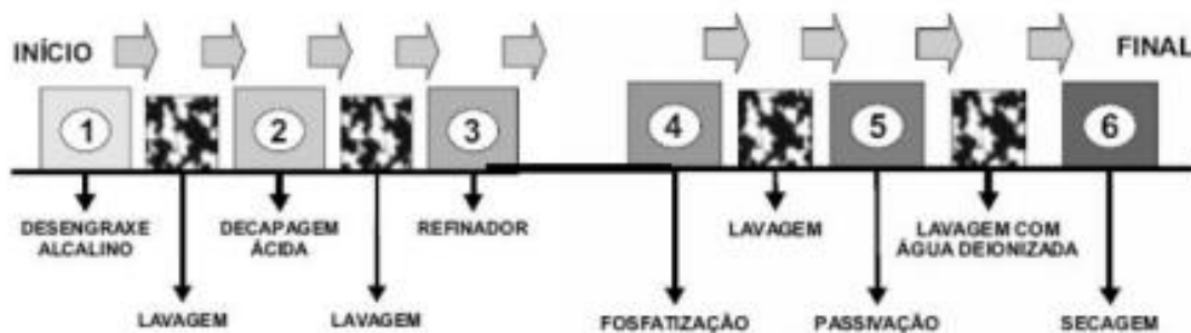
Figura 13: Fluxograma do processo de fosfatização
