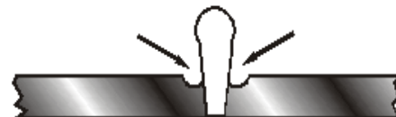
Figura 19: Delaminação do substrato
