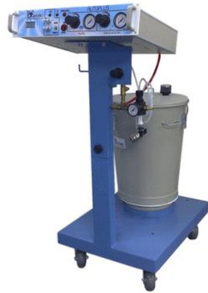
Figura 31: Equipamento de aplicação manual de tinta em pó
