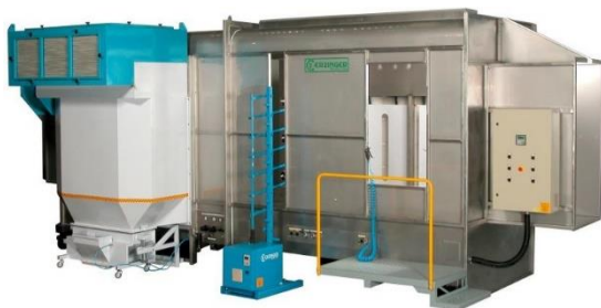
Figura 37: Cabine de pintura, linha contínua
