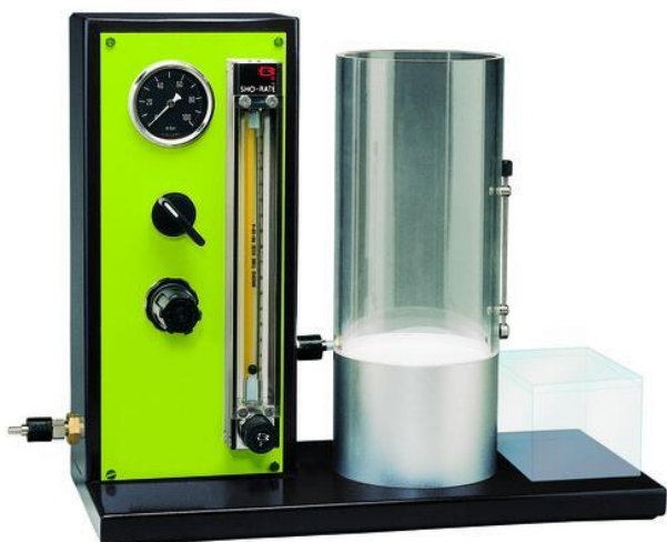
Figura 46: Exemplo de equipamento para análise de fluidização
