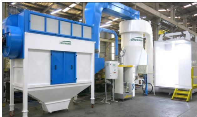
Figura 35: Cabines de pintura estacionária com recuperação tipo cartucho
