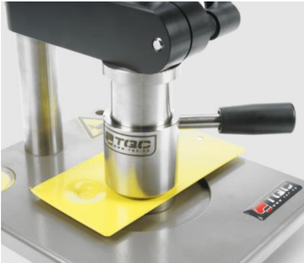
Figura 48: Exemplo de equipamento para teste de impacto
