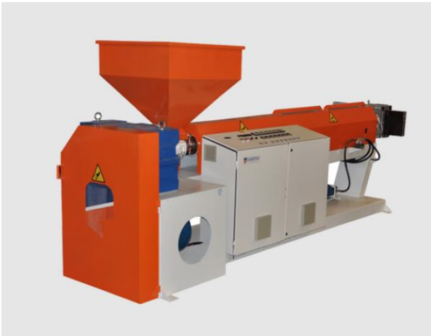
Figura 25: Exemplo de extrusora com esteira compacta
