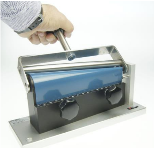
Figura 50: Exemplo de equipamento para determinar a flexibilidade da tinta pó.
