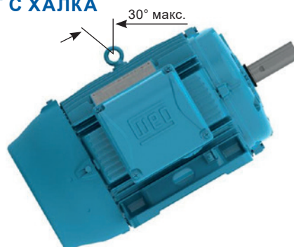
Фигура 4-3 – Максимално допустим ъгъл на наклон за двигатели с един болт с халка
