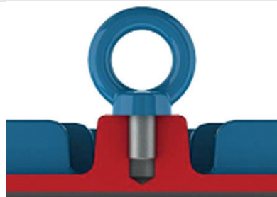
Фигура 4-1 – Правилно затягане на болта с халка
