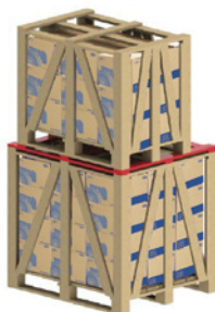
Фигура 5-5 – Използване на допълнителни летви при стифиране
