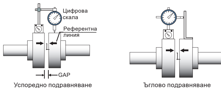
Фигура 6-11 – Подравняване с уреди с цифрова скала
