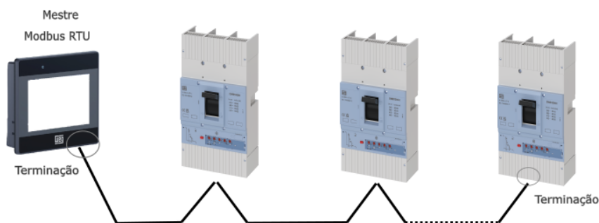
Figura 4.1: Exemplo de instalação em rede Modbus RTU
