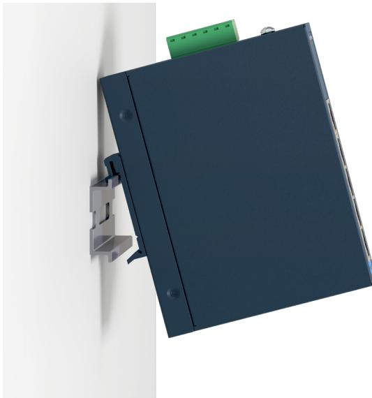
En seguida, baje el dispositivo hasta que se deslice sobre el riel, suavemente. Vea la figura.
