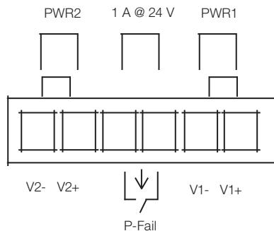
Usted puede conectar un indicador de alarma, timbre u otro equipo de señalización, a través de la salida a relé. El relé se abre si la entrada de energía 1 o 2 falla ("Abierto" significa que si usted conecta la salida a relé a un LED, la luz estaría apagada).
