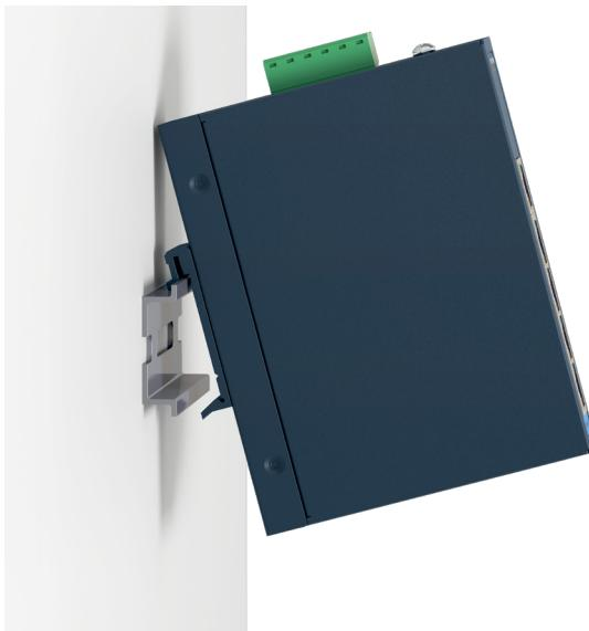
Em seguida, abaixe o dispositivo até deslizar sobre o trilho suavemente. Veja a figura.
