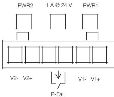
Você pode conectar um indicador de alarme, campainha ou outro equipamento de sinalização através da saída a relé. O relé abre se a entrada de energia 1 ou 2 falhar ("Aberto" significa que se você conecta a saída a relé a um LED, a luz estaria apagada).
