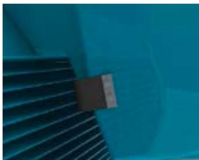
图3 - 无火花防爆型和API541型电机使用的接地条
