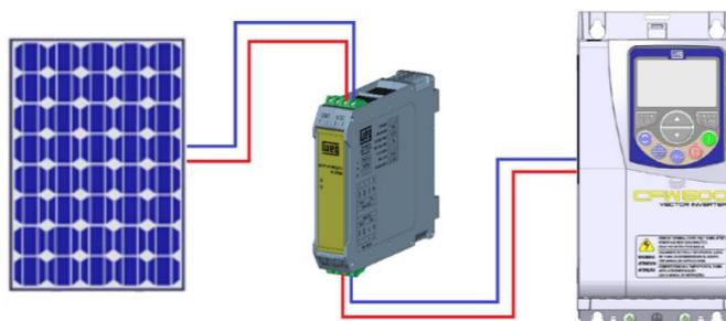
**Figura 5.2 – Detección de la radiación solar mediante el Detector Solar.**
