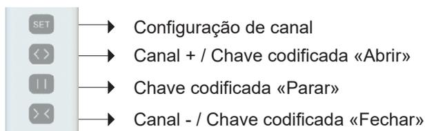
O controle Remoto Multi Canais RF WEG Smart Home tem como função transmitir um sinal RF (radiofrequência) com frequência de 433,92 MHz, codificação 1527 e modulação OOK. Este produto tem um display de exibição digital de 7 segmentos, que pode exibir um total de 9 canais de 0 a 8. Diferentes canais podem ser trocados livremente pressionando o botão **SET** e diferentes ações podem ser executadas quando o receptor recebe diferentes valores de chaves codificadas.
