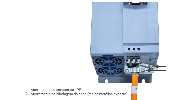
Figura 9.2: Conexões de saída e aterramento do motor
