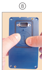
Colocar a tampa e girar no sentido horário
