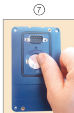
Pressionar a bateria para o encaixe
