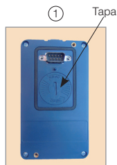
Ubicación de la tapa de acceso a la batería
