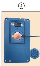
Remover a bateria com o auxílio de uma chave de fenda posicionada no canto direito
