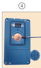
Quitar la batería con la ayuda de un destornillador posicionado en el canto derecho
