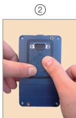
Presionar y girar la tapa en el sentido antihorario
