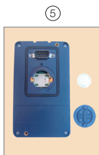
HMI sin la batería
