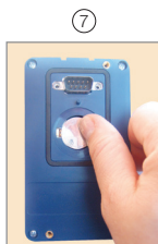
Presionar la batería para que la misma encaje
