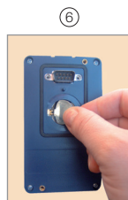
Colocar la nueva batería posicionándola primero en el canto izquierdo
