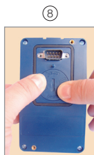
Colocar la tapa y girar en el sentido horario
