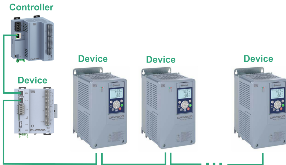
Figura 2.6: Topología en cadena (daisy-chain) PROFINET.
