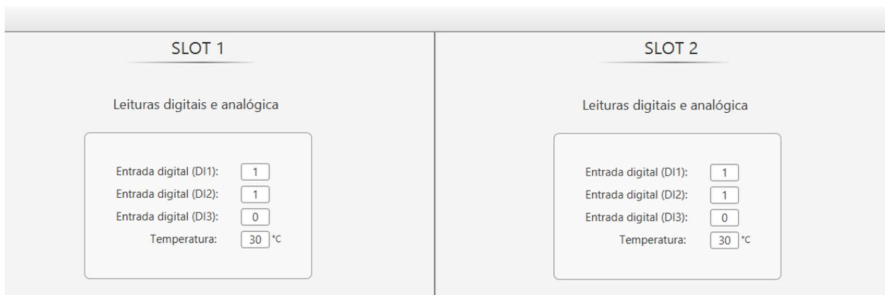
**Figura 6.2:** Interface do Assistente WPS para monitorar parâmetros, produto com 2 slot.
