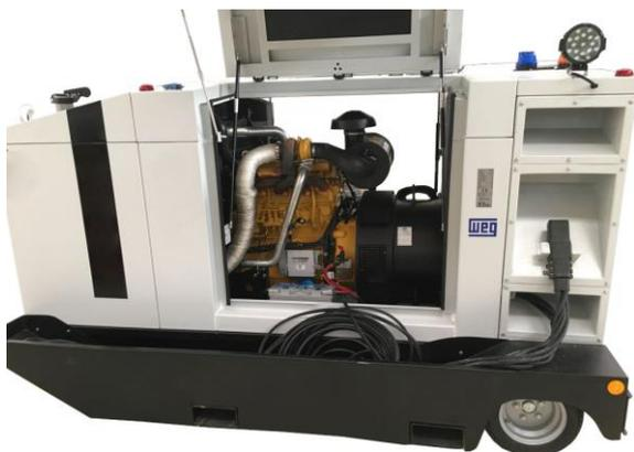
**Figura 1:** GPU com alternador G Aircraft
