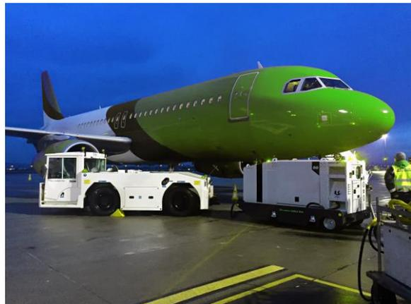
**Figura 2:** Aeronave alimentada eletricamente por um GPU
