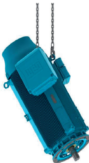
Rysunek 4.17: Podnoszenie silników HGF, W50 i W51 HD za pomocą śrub oczkowych po stronie przeciwnej do napędu
