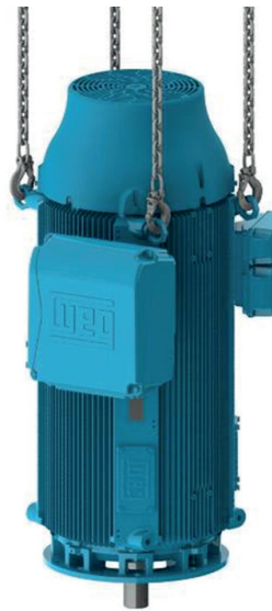
Rysunek 4.9: Podnoszenie silników HGF
