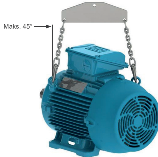
Rysunek 4.4: Maksymalny kąt wynikowy dla silników z dwoma lub więcej śrubami oczkowymi do podnoszenia
