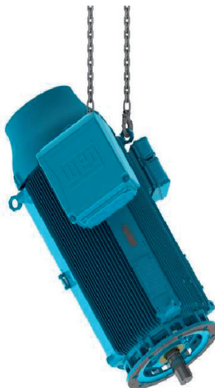
Figur 4.17: Lyft HGF-, W50- och W51 HD-motorer med öglebultarna på den icke-drivna änden
