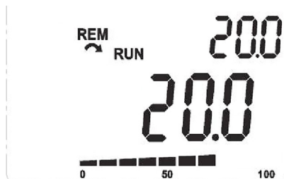
Рисунок 16.3: Пример ЧМИ в режиме мониторинга для использования ПИД-контроллера
