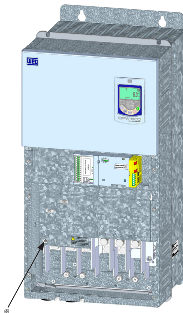
Rysunek A.4: Lokalizacja punktów odłączenia uziemienia kondensatorów filtra - śruby korytka odłączającego - rozmiary ramy F i G
