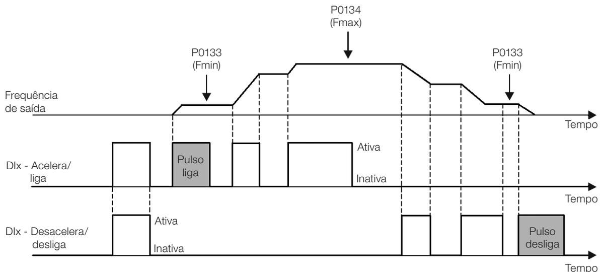
**Figura 15.16:** Exemplo da função Acelera liga/Desacelera desliga
