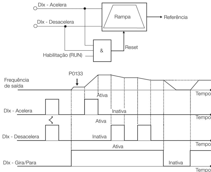
**Figura 15.13:** Exemplo da função Potenciômetro Eletrônico (E.P.)
