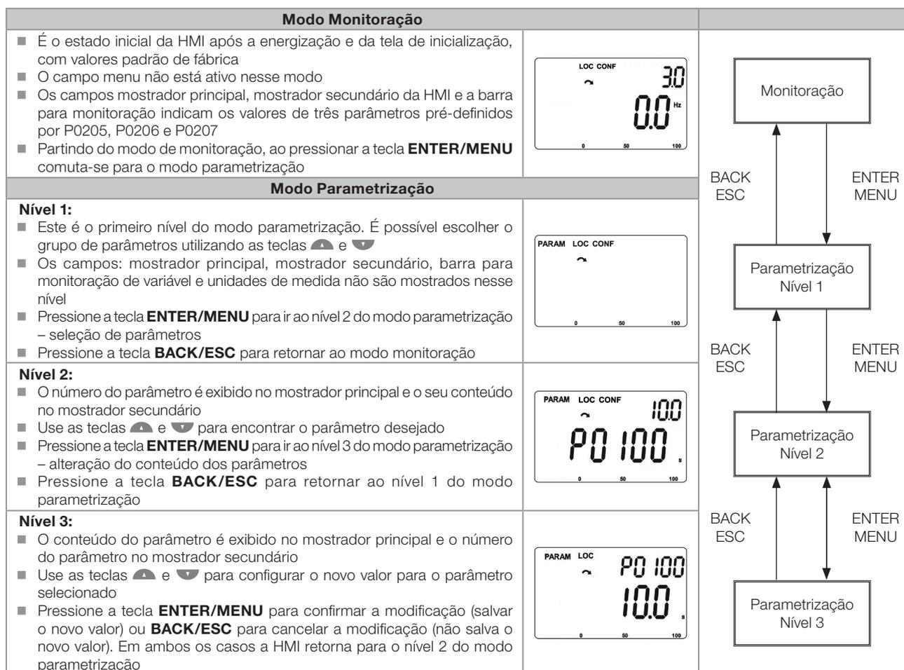
*Figura 4.5: Modos de operação da HMI*
