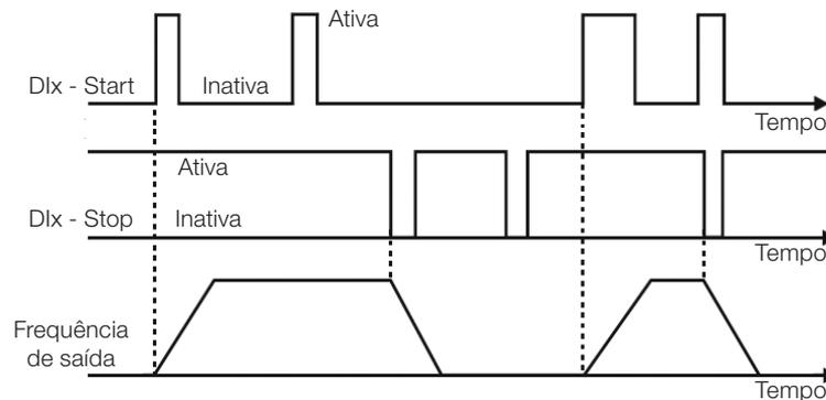
**Figura 15.10:** Exemplo da função Start/Stop três fios
