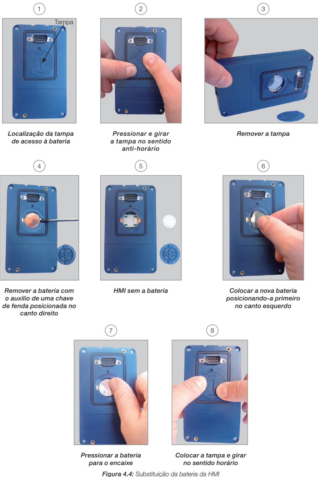
Figura 4.4: Substituição da bateria da HMI
