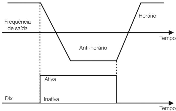
Figura 15.11: Exemplo da função Sentido de Giro
