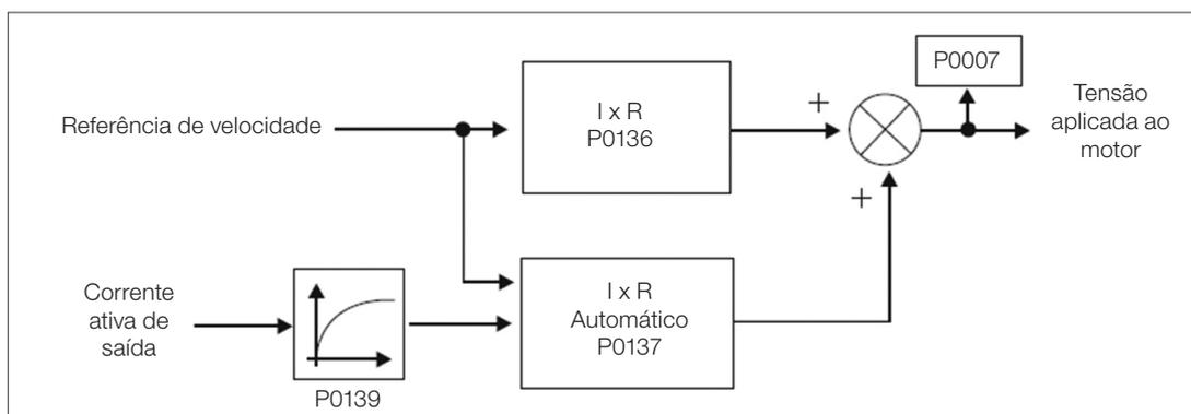
Figura 9.4: Blocodiagrama do boost de torque automático
