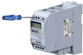
(d) Tighten the screws of the supply terminal of the CFW100 (Torque: 0.6 N/m) (d) Apriete los tornillos del borne de alimentación del CFW100 (Torque: 0.6 N/m) (d) Aperte os parafusos do borne de alimentação do CFW100 (Torque: 0.6 N/m)
