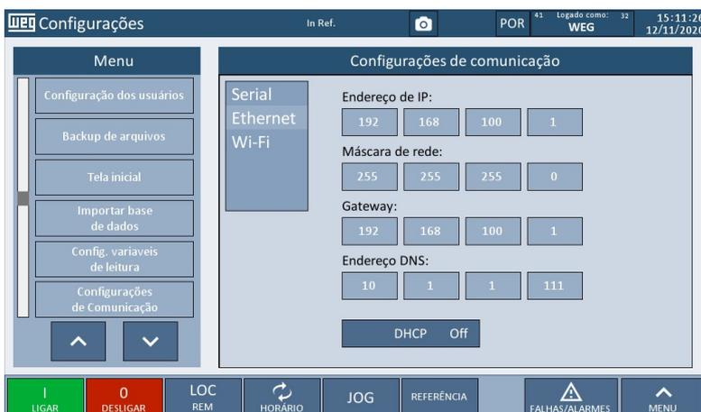
**Figura 4.26** – Configurações da porta Ethernet
