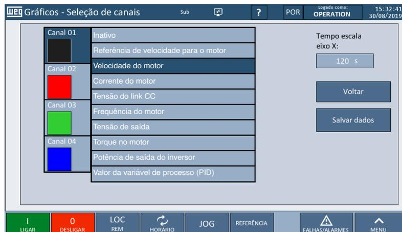
Figura 4.15 – Configuração dos canais
