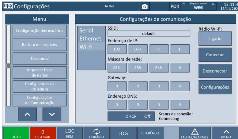
Figura 4.27 – Configurações e status da comunicação WI-Fi
