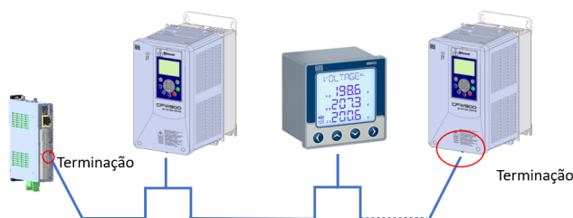
Figura 3.2: Instalação física do ED200-MOB na rede modbus.
