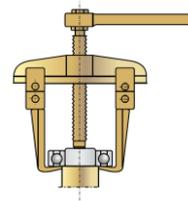
Figura 7.8: Dispositivo para sacar o rolamento
