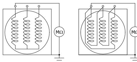
Figura 4.4: Conexão de megôhmetro
