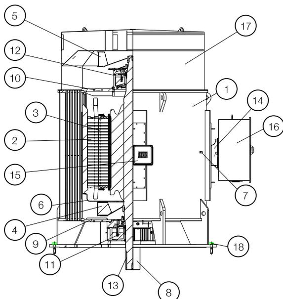
Figura 8.1: Vista geral de um motor típico de eixo sólido com mancais de rolamento a óleo
