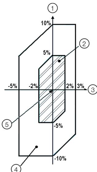
Figura 2.1: Limites das variações da tensão e frequência
