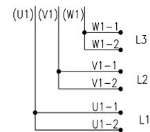
Figura 4.8: Conexões paralelas
