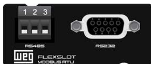
Figura 3.15: Acessório de comunicação ModBus RTU.
