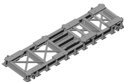
Figura 3.2: Ejemplo de base metálica común
