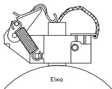
Figura 7.3: Escova para aterramento do eixo
