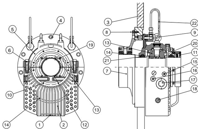
Figura 7.9: Partes do mancal de deslizamento
