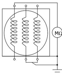
Figura 4.2: Conexão do megôhmetro em fases separadas
