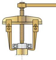
Figura 7.8: Dispositivo para sacar o rolamento
