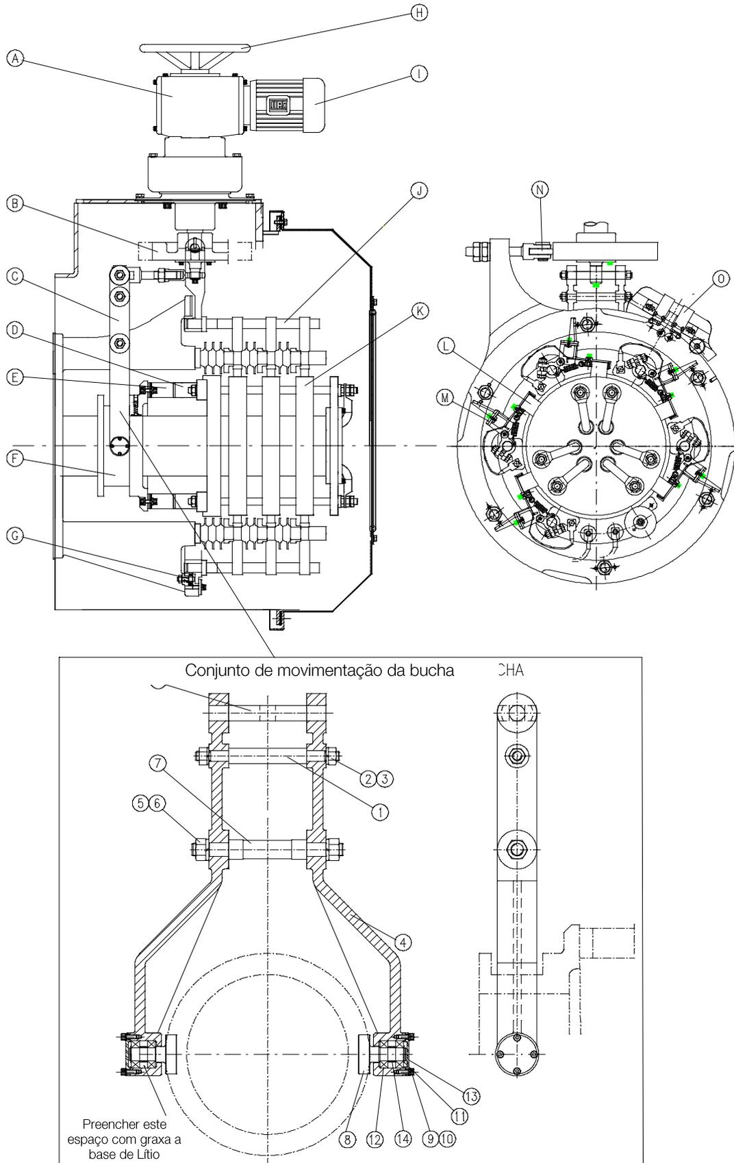
Figura 7.11: Sistema de levantamento das escovas
