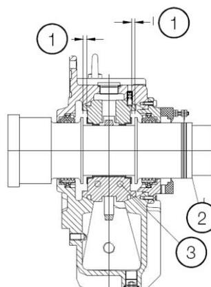
Figura 4.15: Mancal de deslizamento
