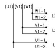
Figura 4.6: Conexões paralelas
