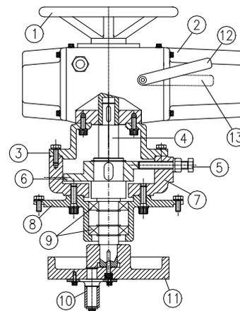
Figura 7.12: Partes do atuador eletromecânico
