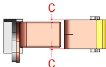
Figura 7.17: Alinhamento lateral dos contatos de curto-circuito macho e fêmea
