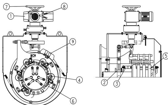
Figura 5.1: Dispositivo para levantamento das escovas
