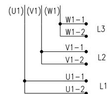
Figura 4.5: Conexões paralelas
