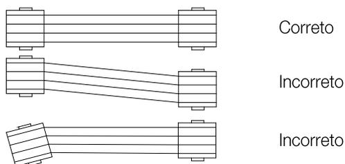
Figura 4.14: Acoplamento por polias e correias
