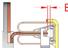
Figura 7.16: Contato de curto-circuito fechado
