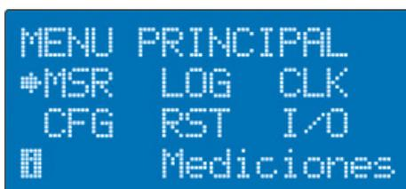
Opciones para ver las mediciones (MSR), Registro de datos (LOG), fecha y hora (CLK), configuraciones (CFG), borrar los valores de los acumuladores de las mediciones (RST) y alarmas (I/O)
