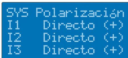
Ajuste la polaridad de los sensores de corriente (+) indica el sentido directo (de acuerdo con la seta del sensor), mientras (-) indica el sentido inverso
