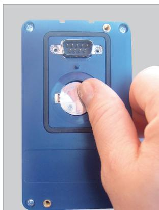
Appuyer sur la batterie pour l'insérer
