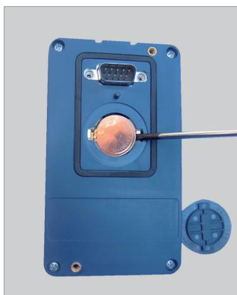
Sortir la batterie à l'aide d'un tournevis placé sur le côté droit
