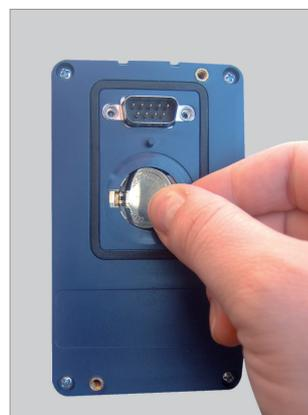
Installer la nouvelle batterie en la positionnant d'abord à gauche
