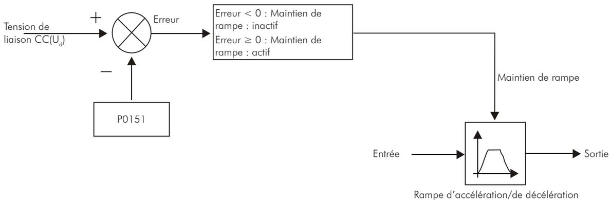
Figure 9.10 - Schéma de principe de la limitation de la tension de liaison CC en utilisant la fonction Maintien de Rampe
