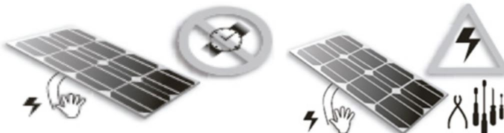
Figura 1.2: Cuidado com o uso de adereços e ferramentas metálicas ao manusear o módulo.
