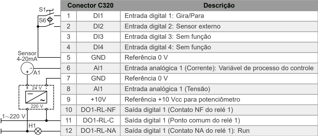
Figura 4.31: Sinais no conector do cartão de controle C320 para proteção da bomba via sensor externo em uma entrada digital
