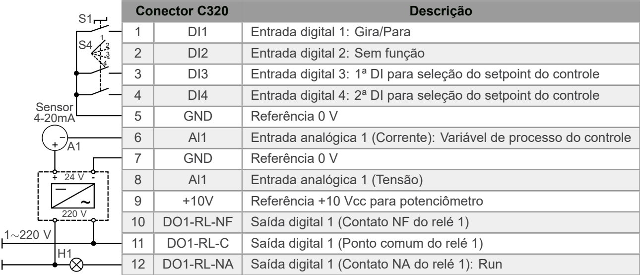
Figura 4.8: Sinais no conector do cartão de controle C320 para setpoint do controle via combinação lógica de entradas digitais
