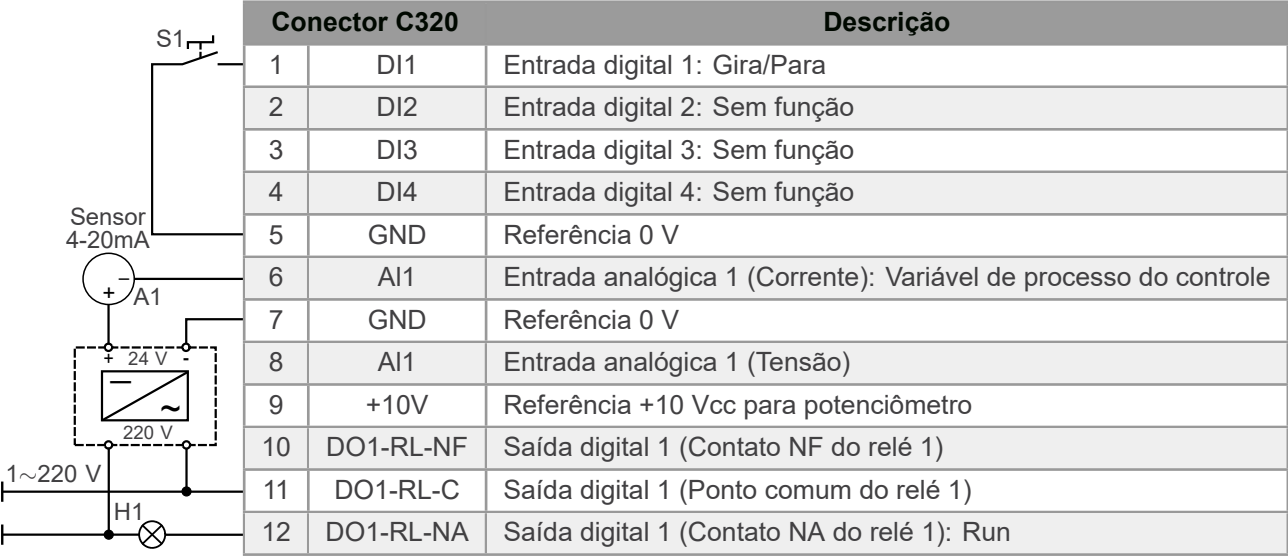
Figura 4.2: Sinais no conector do cartão de controle C320 para setpoint do controle via HMI ou redes de comunicação
