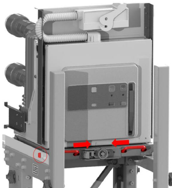
Figura 7.2: Accionamiento de las alzas para mover las trabas y posicionar/trabar el Interruptor en el carrito de mantenimiento.
