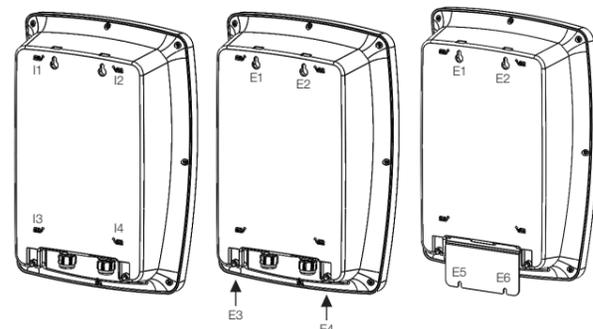
Figura 4.2: Métodos de fijación de la WEMOB-WALL
