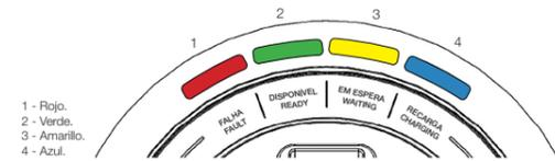
Figura 6.1: LEDs de señalización
