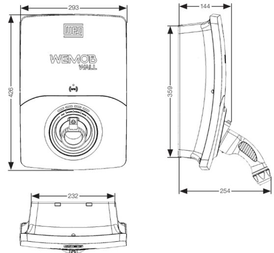
Figura 7.1: Dimensiones de la estación de recarga WEMOB-WALL en mm
