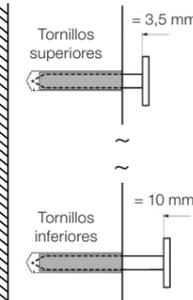
Para fijación con el soporte metálico, introduzca los cuatro (04) tornillos (E1, E2, E5 y E6) y apriételes dejando una distancia de 3,5 mm de la pared para los tornillos superiores (E1 y E2). Los tornillos inferiores (E5 y E6) pueden ser apretados hasta el final.
