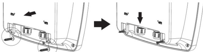
Detalle encaje inferior (tornillos E3 y E4 - sin soporte metálico)
