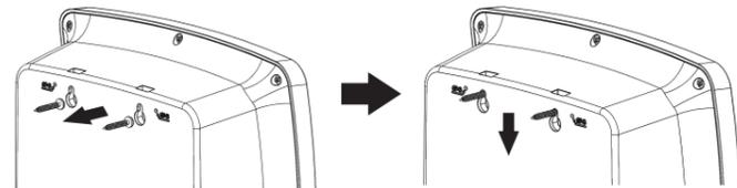
Detalle encaje superior (tornillos E1 y E2)
