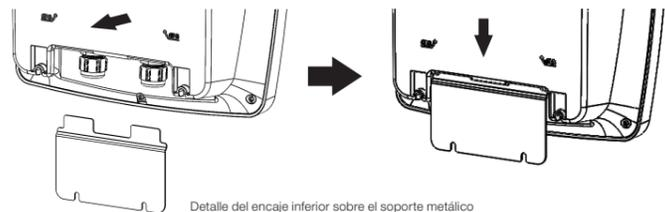
Detalle del encaje inferior sobre el soporte metálico
