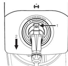
Figura 5.3: Procedimiento para retirada del plug del stecker
