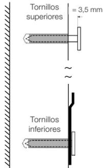
6. Aproxime la estación de recarga a los puntos de fijación superiores (E1 y E2), alinee la abertura mayor con las cabezas de los tornillos y deslicela hacia abajo hasta su completo encaje sobre los tornillos (E3 y E4) o sobre el soporte metálico.
