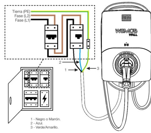
Figura 5.2: (a) y (b) ejemplos de conexión eléctrica monofásica (L1-N-PE) y bifásica (L1-L2-PE)
