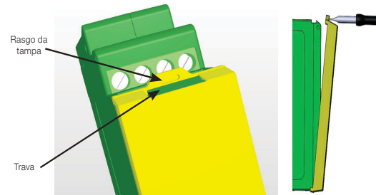
Figura 7: Retirada da tampa frontal
