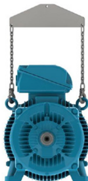
Рисунок 4.5 – Использование траверсы для подъема.
