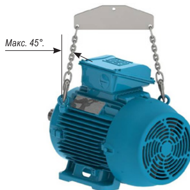
Рисунок 4.4 – Максимальный результирующий угол для двигателей с двумя или более подъемными рым-болтами.
