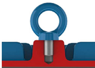
Рисунок 4.1 – Правильная затяжка рым-болта
