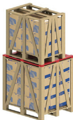
Рисунок 5.5 – Использование дополнительных реек для штабелирования
