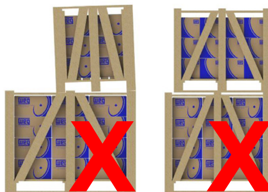
Рисунок 5.4 – Неправильное штабелирование X
