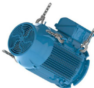
Рисунок 4.12 – Мотор поворачивается в горизонтальное положение
