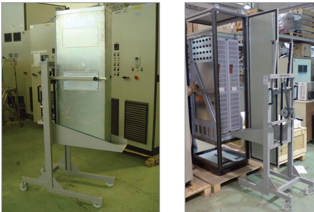
Figura 19 - Detalhes do carrinho e da operação de retirada do book
