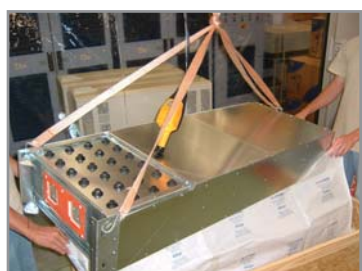
7º Passo – Remover o Modular Drive da embalagem com auxílio da talha. (***)
