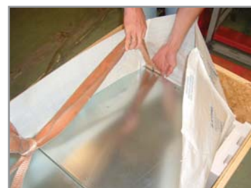
6º Passo – Encaixar os ganchos da talha nos olhais superiores e na base do Modular Drive.
