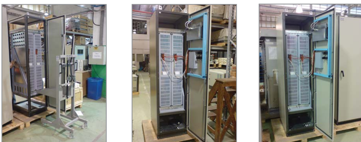
Figura 29 - Vista carrinho de extração e vistas internas de painéis
