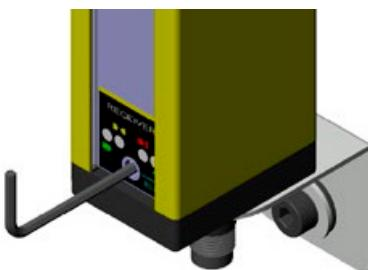
**Figura 6.7:** Pressione o botão de programação usando a ferramenta
