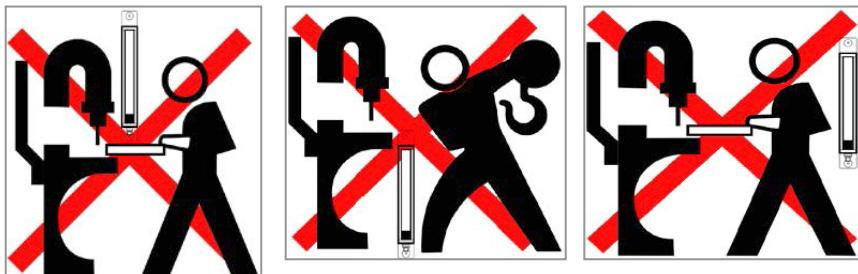
*Figura 3.5: Posicionamiento incorrecto del LSP*
