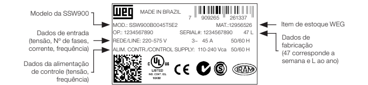
Figura 5.1: Etiqueta de identificação na lateral da SSW900
