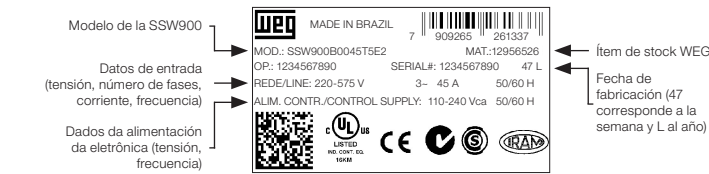
Figura 5.1: Etiqueta de identificación en la lateral del SSW900
