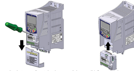
(a) Remoção da tampa frontal e do acessório (b) Conexão do acessório
