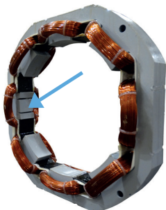
Figura 1: imanes permanentes en el estator de la excitatriz
