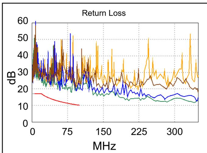
O PS Return Loss é o somatório do efeito Return Loss de um par sobre os outros 3 pares do cabo.
