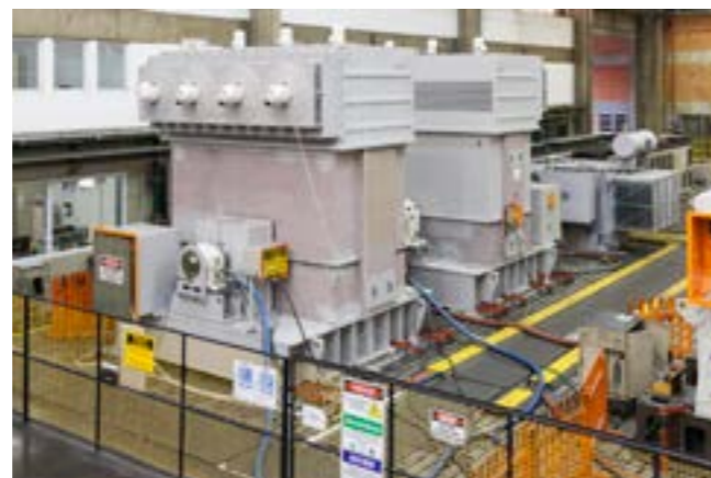
WEG 实验室 - 在我们的测试设施内进行负载测试
