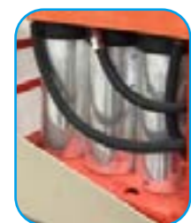
WEG制造的用于直流母线电压源的长寿命塑料薄膜电容器 (与航空航天工业在卫星中使用的电容器相同)
