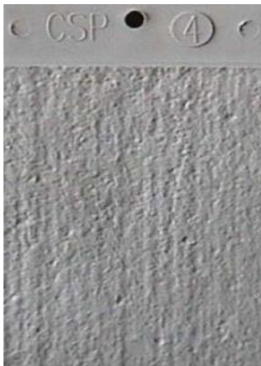
Figura 13 - Referência da preparação de superfície, conforme Padrão CSP 4
