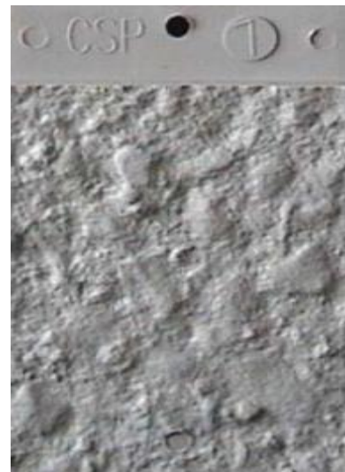
Figura 12 - Referência da preparação de superfície, conforme Padrão CSP 7
