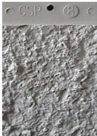
Figura 16- Referência da preparação de superfície, conforme Padrão CSP 8
