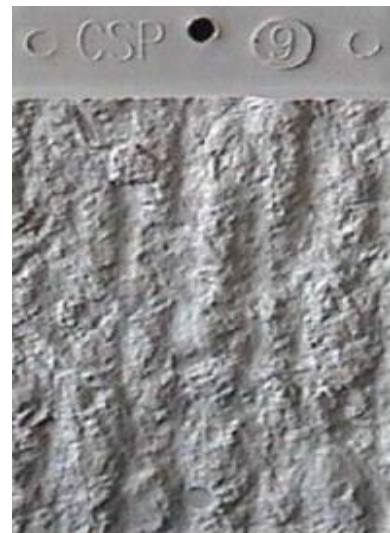
Figura 15 - Referência da preparação de superfície, conforme Padrão CSP 9
