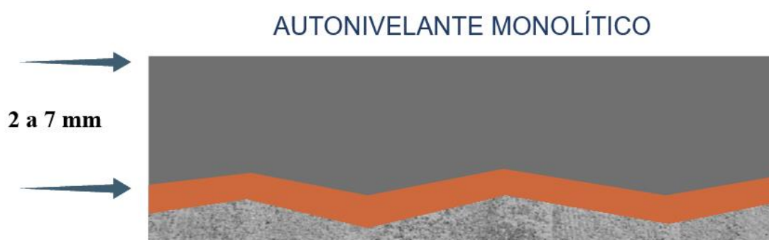
Figura 39 - Piso autonivelante monolítico Fonte: Treinamento WEG (2020)
