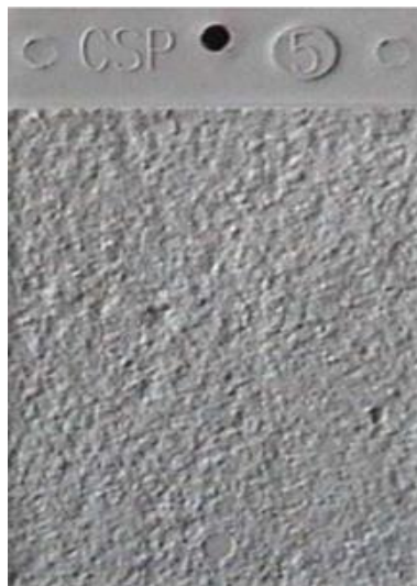
Figura 11 - Referência da preparação de superfície, conforme Padrão CSP 5
