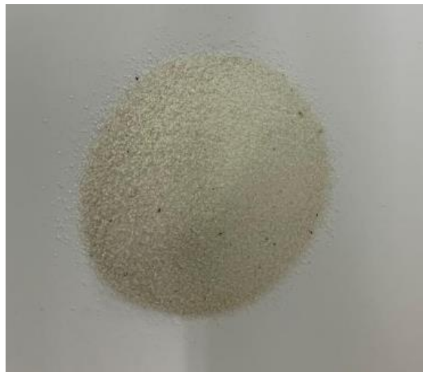
Figura 32 - Agregado MIX 30 Fonte: O autor (2020)
