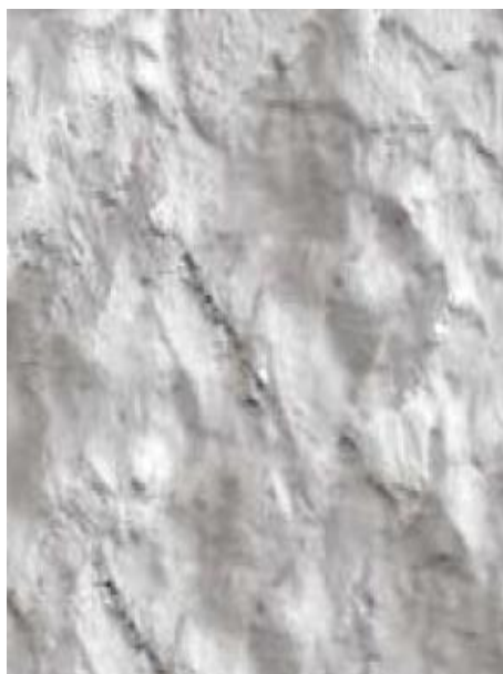
Figura 17 - Referência da preparação de superfície, conforme Padrão CSP 10 Fonte: NACE (2018)
