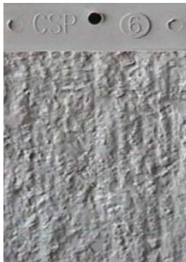
Figura 14 - Referência da preparação de superfície, conforme Padrão CSP 6
