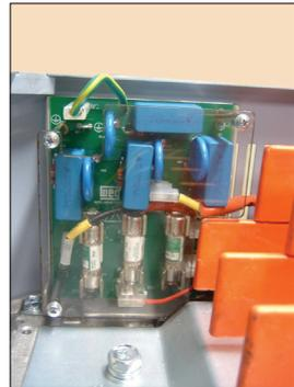
断开接地的RFI滤波器和MOV的流程 - 在IT或B相接地三角网络中使用变频器的必要流程
