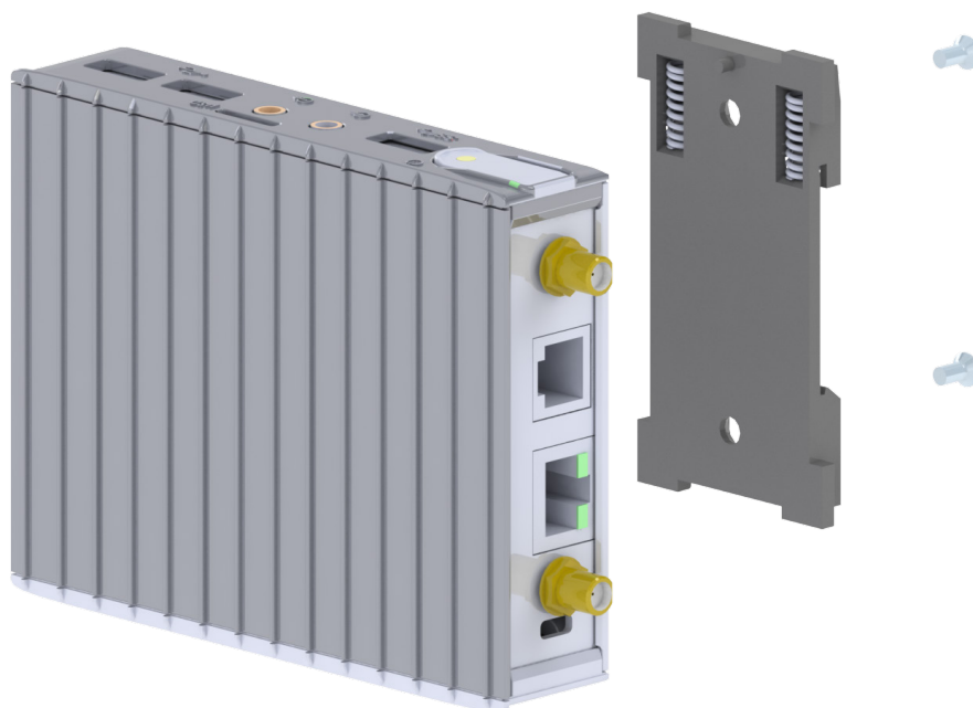
Figura 2.1: Fixação WCD-ED300 para trilho DIN (vista explodida)
