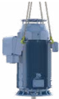
图9 - 起吊立式电机
