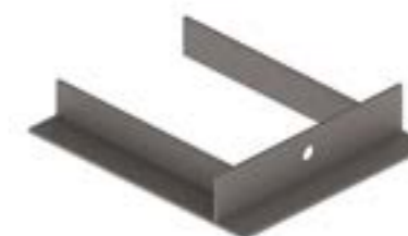
图44 - 带滑动轴承的电机的轴锁紧装置
