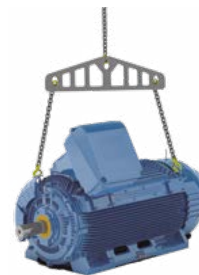
图8 - 采用倾斜吊链起吊
